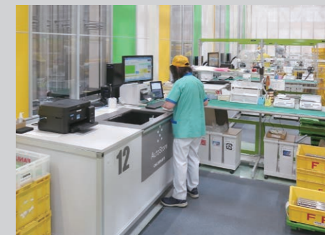
出庫用ポートの横には、小さな部品などの仕分け作業用に天板が電動昇降する作業台を配置。
