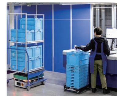
ポートでの出庫作業後は、無人搬送機で次工程へ。作業者の負担を軽減し、ピッキングや搬送にかかる歩行時間も削減。
