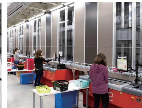
入出庫作業を行うポート(ピッキングステーション)
